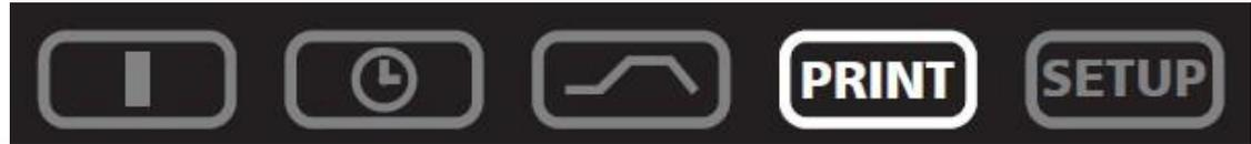
可打印箱体运行数据的图表，需用数据线连接箱体和喷墨打印机
